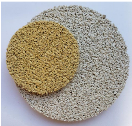
Abbildung 3: Bei beiden Farben handelt es sich um die Farbe Eggshell; die kleinere Fläche wurde jedoch mit aromatischem (= nicht-lichtechtem) Bindemittel erstellt.
