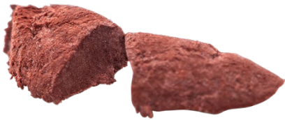
Abbildung 4: Ein aufgeschnittenes EPDM Granulat bei dem die durchgängige Einfärbung deutlich erkennbar ist
