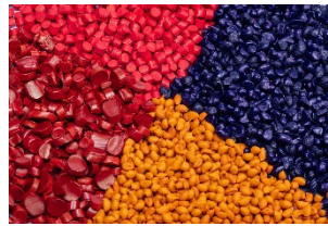
Abbildung 5: Verschiedene Farb-Masterbatche in Granulatform
