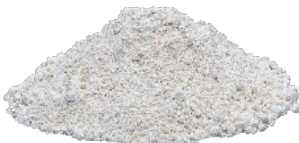
Abbildung 2: Kreide ist ein typischer Füllstoff von EPDM Granulaten
